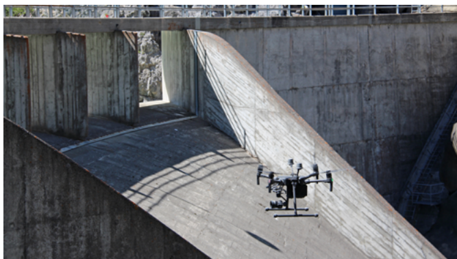
Bild 4: Drohnen-einsatz für Nahbereichsphotogrammetrie einer Staumauer Oberfläche (Bild: Schneider Ingenieure AG).
