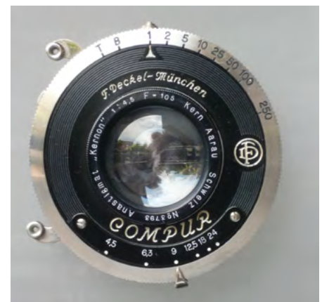
Abb. 5: Kern Objektiv montiert in Compur-Verschluss.
