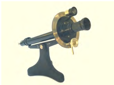
Abb. 3: Das Polarimeter, ein medizinisches Analysegerät zur Bestimmung von Zucker und anderen optisch aktiven Stoffen in Flüssigkeiten.
