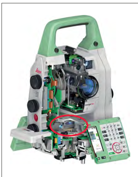
Abb. 7: Schnittmodell ScanStation mit Flüssigkeitskompensator.
